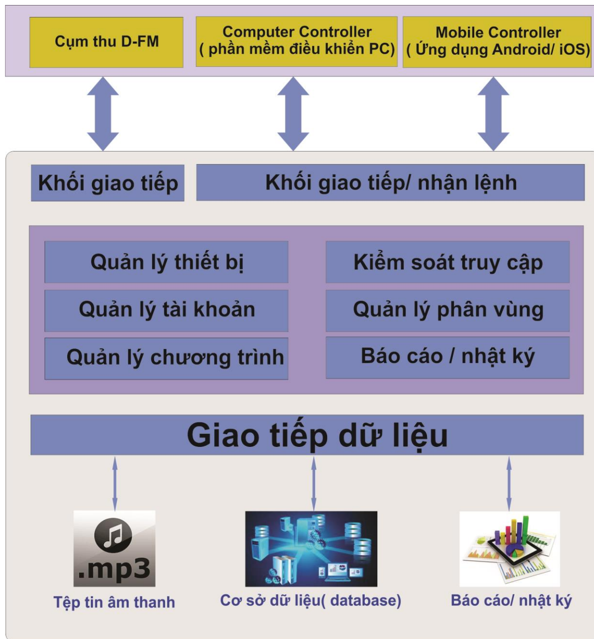
( Hình mô tả thiết kế các khối chức năng, xử lý của giải pháp Truyền thanh ứng dụng CNTT-VT Mobile Controller (Android/iOS) )
